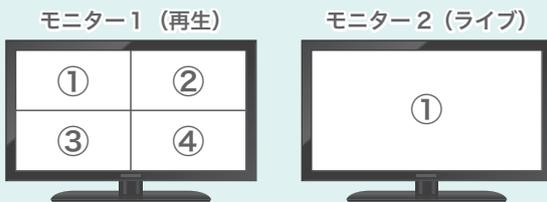
2つのモニターに**異なる映像を出力**します。再生時、**モニター1を再生、モニター2をライブ表示**にできます。
